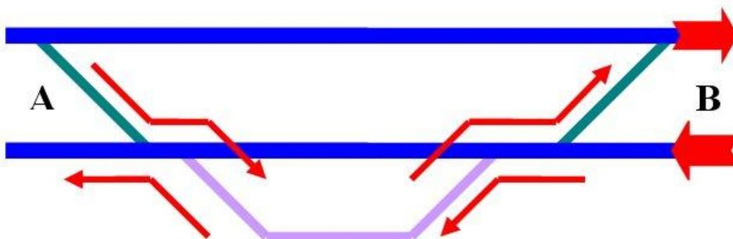
Méthode que nous aurons vite fait de « compacter » en remplaçant les quatre aiguillages présents sur la voie circulant de B vers A par deux traversées-jonction simples.
