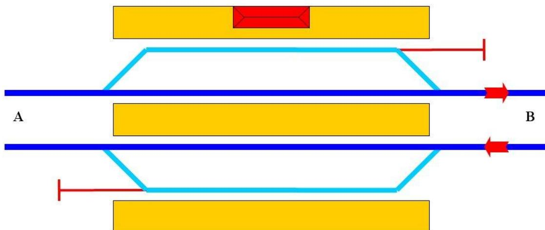
On remarque immédiatement que l'emprise de notre gare s'étend très rapidement... On note aussi que les aiguilles de sécurité ne sont nécessaires que dans le sens de la marche. Dans l'autre sens, on ne circule normalement pas. Pour la disposition des quais, plusieurs choix s'offrent à vous. Vous pourriez très bien préférer les installer entre voies principale et de débord.
