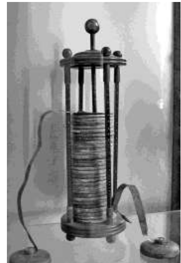
Pile de A. Volta à Tempio Voltiano Côme Source Internet CCBY-SA3.0
