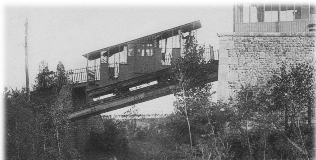
Une des cabines du funiculaire de Namur à son arrivée au terminus du Grand-Hôtel. On distingue les deux plates-formes de chargement destinées au chargement des bagages ou au personnel d'accompagnement. Le compartiment central est fermé. (Collection Henri COULON)
