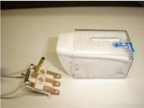
03 Dans le trou coller un tube de laiton de 2/3mm, longueur 30 mm. Couper le couvercle pour le passage du tube.
