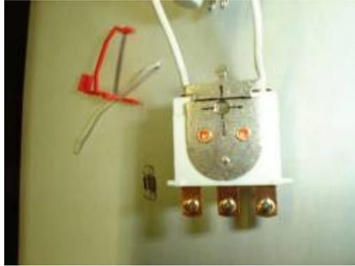
02 Ouvrir me relais (cure-dents et petit tournevis) éliminer le contact central et forer ici (à la main)un trou de 3mm.
