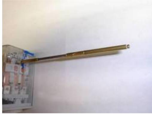
08 Coller 10 mm de tube laiton, enfiler un morceau de 30 mm (libre), fermer avec un tout petit bout de tube 2/2,5mm
