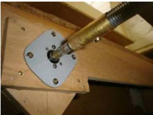
11. Fixation du moteur de foreuse et adaptateur.
