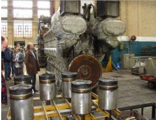
Le démontage complet d'un moteur
