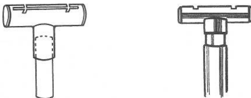
FIG 8.1 (ci-dessus à gauche), 8.2 (ci-dessus à droite) et 8.3 (ci-dessous) LES 2 ENCOCHES DE GUIDAGE. Noter qu'en réalité la profondeur des encoches de guidage est moindre qu'ici ; on l'ajustera lors d'essais ultérieurs.
