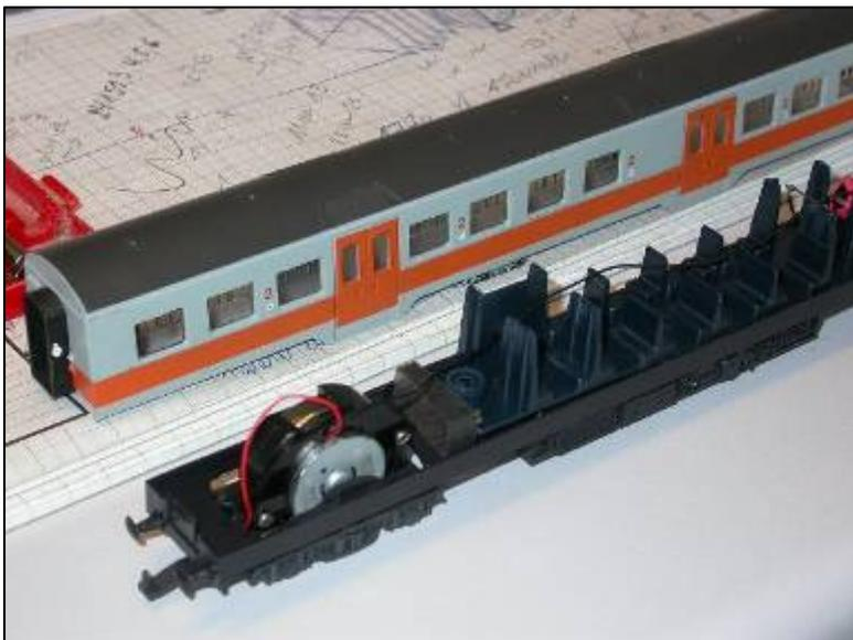
et pouvons maintenant reconnecter la prise de courant au boggie porteur. Souder à l'extrémité du fil noir relié au moteur un bout de fil suffisamment long pour atteindre le boggie porteur. Réutilisez par exemple le fil de l'ancien moteur. A l'autre extrémité de ce fil, soudez le composant électrique fourni avec le kit (peut importe le sens) et soudez l'autre bout du composant à la pince qui maintient le boggie porteur. Attention, pour éviter de fondre votre châssis en
