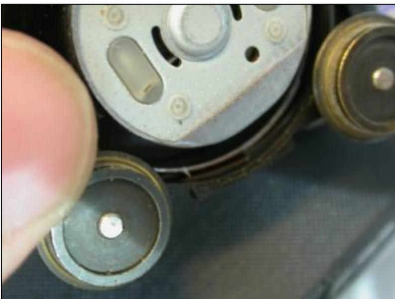
Fixons le nouveau moteur dans l'espace ainsi créé en le vissant dans les trous de vis de l'ancien capot. Prenons soin de vérifier la libre rotation du nouveau moteur et des roues, il faut peut-être régler la position sur son axe de l'engrenage solidaire du nouveau moteur. Soudons dès à présent le fil rouge du moteur sur l'ergot du capteur de courant du boggie moteur.
