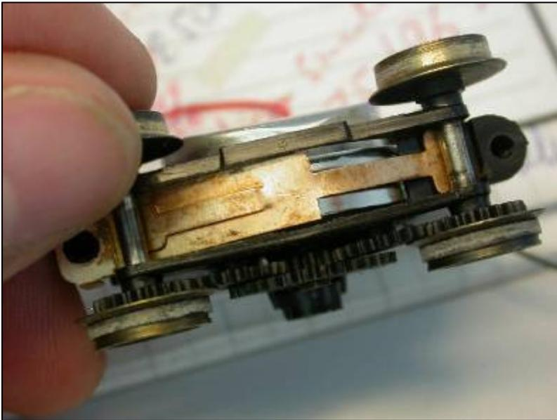
Remarquons que l'aimant permanent qu'il faut retirer sert ici également à maintenir le frotteur de prise de courant situé dans le boggie moteur. L'aimant est en fait constitué d'un anneau métallique et d'un ruban de « caoutchouc » aimanté. Ces deux pièces peuvent facilement être désolidarisées. Il faut donc remettre l'anneau métallique, sans l'aimant, à sa place afin d'assurer le
