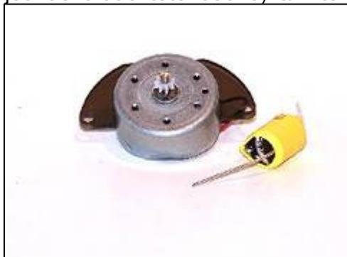
moteur de petite taille se logera dans l'espace laissé libre par le rotor et l'aimant permanent du moteur d'origine, une fois ces derniers retirés. Le moteur ModelTorque dispose de deux oreilles de fixation percées par deux trous dont l'entraxe correspond exactement avec l'entraxe des vis retenant le capot d'un moteur Lima d'origine.
