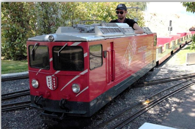
La motrice la plus ancienne du parc en catégorie Electricité : une MGB Matterhorn Gothard Bahn. Elle était mue par un moteur thermique qui fut remplacé lors de sa révision par une génératrice Honda alimentant 2 moteurs électriques. C'est une réplique d'une locomotive circulant sur la ligne de la Furka.
