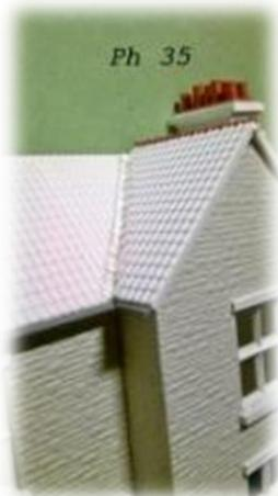
On terminera alors en posant les solins de zinc à la jonction des pans de toiture ainsi qu'à la jonction de la cheminée et de la toiture. Ils seront réalisés en bandes de papier de 120 gr/m<sup>2</sup> de 5 mm de large pliée en deux et coupées à 5 mm de longueur, puis collés à la colle pour plastique « Revell Contacta Liquid », partant du bas vers le haut de la toiture (photos 35
